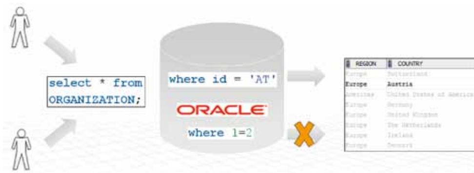
Abbildung 6: Funktionsweise von VPD
