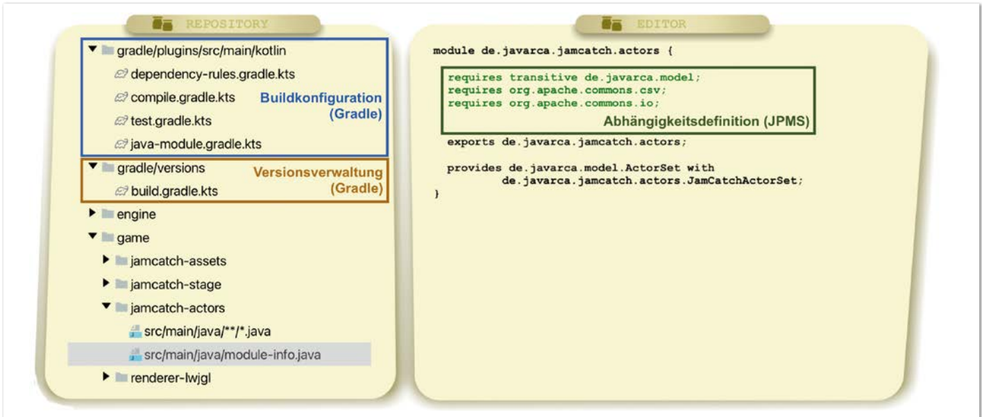
Abbildung 4: Projekt mit module-info.java Dateien zur Abhängigkeitsdefinition und Gradle als Build-Tool (© Jendrik Johannes)
