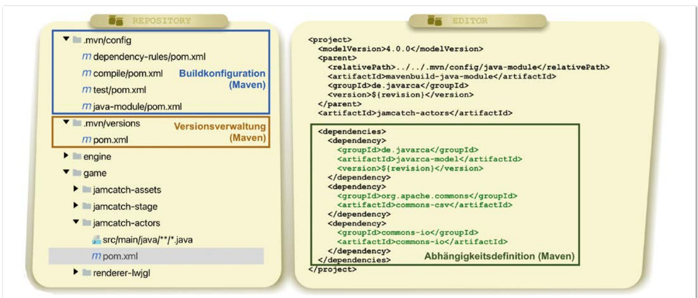
Abbildung 3: Projekt mit Maven zur Abhängigkeitsdefinition und Maven als Build-Tool (© Jendrik Johannes)
