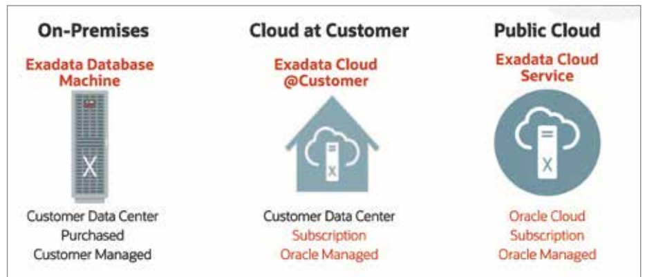
Abbildung 1: Exadata-Deployment-Modelle (Quelle: © Oracle)
