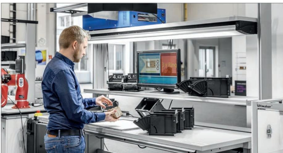
Abbildung 2: Kamerabasiertes Assistenzsystem für Montagearbeitsplätze (© Michael Neuhaus – Fraunhofer IML)
