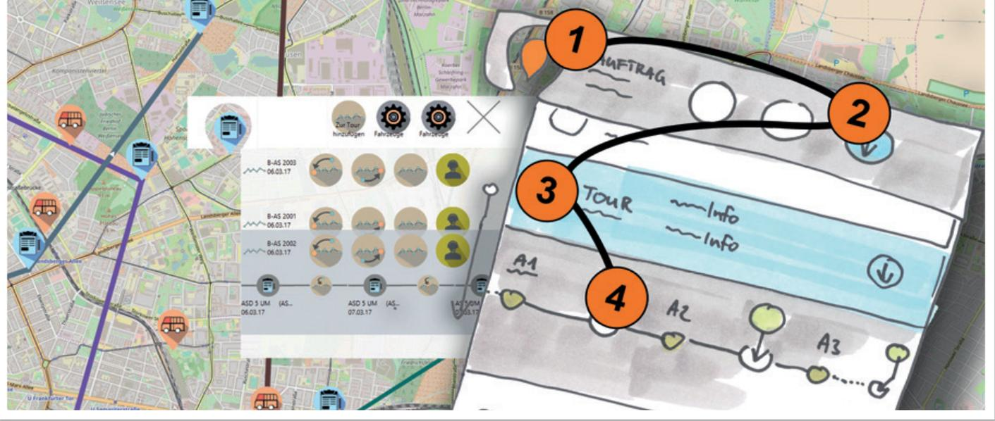
Abbildung 6: Workflow im Benutzerdialog „Auftragszuordnungen“ (Paperprototyping + Prototyp). 1 – Auftragsobjekt auswählen, 2 – Funktionswahl Tour-Zuordnung, 3 – Tourenauswahl betrachten, 4 – Position in Tour wählen
