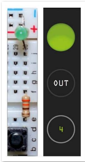
Abbildung 5: Ein Kanal der Schaltung wird in der UI durch eine Spalteneinheit repräsentiert
