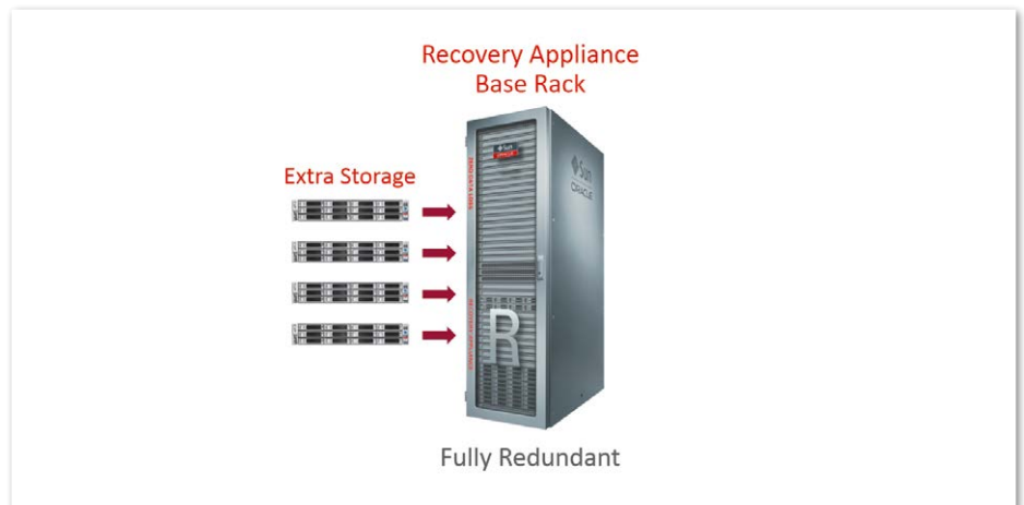
Abbildung 5: Base Rack und Kapazitätserweiterung
