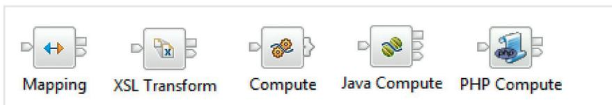
Abbildung 3: WebSphere Message Broker Transformation Nodes
